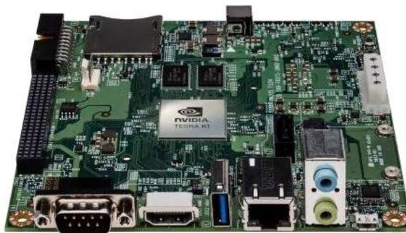
Figura 3 – Plataforma MPU-GPU Nvidia Jetson-TK1 (NVIDIA, 2016a).
