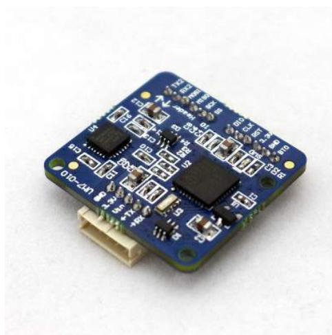
Figura 11 – IMU para estimação de orientação triaxial (CHROBOTICS, 2016).
