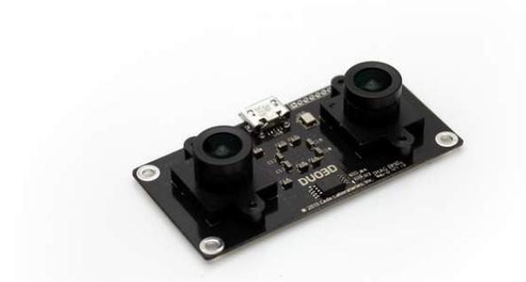
Figura 12 – Sistema embarcado de visão estéreo DUO M (LABORATORIES, 2016b).
