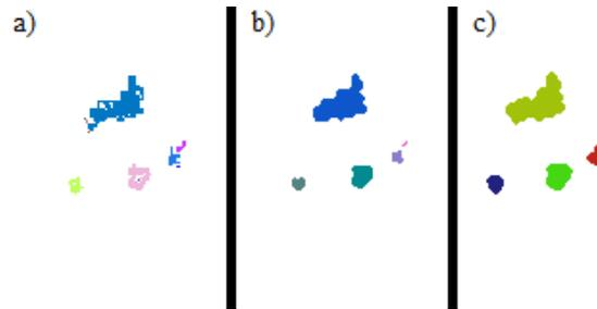
Figura 46 – Representação gráfica de um matriz  $K$  exemplo. (a) Sem filtro de mediana e sem dilatação. (b) Com filtro de mediana e sem dilatação. (c) Com filtro de mediana e com dilatação.
